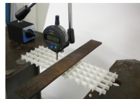
図-7 曲げ試験 (ハニカム板) 図-8 曲げ試験 (格子板)
